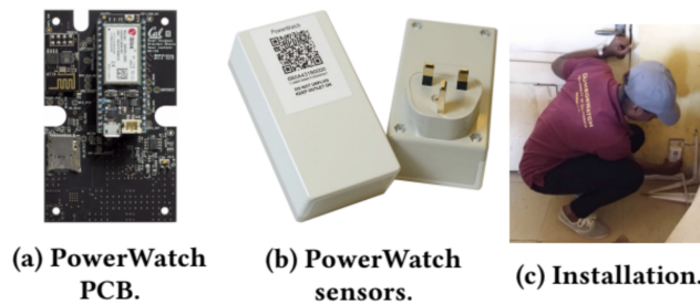
FIGURE 3 – PowerWatch déployé. (a) PowerWatch PCB (circuit imprimé) avec la radio cellulaire, la carte SD, et les circuits de détection. (b) Capteurs PowerWatch assemblés, avec un QR code scanné au moment de l’installation pour associer le capteur à un participant (c) Un agent de terrain installe un capteur PowerWatch sur une prise de courant domestique.
